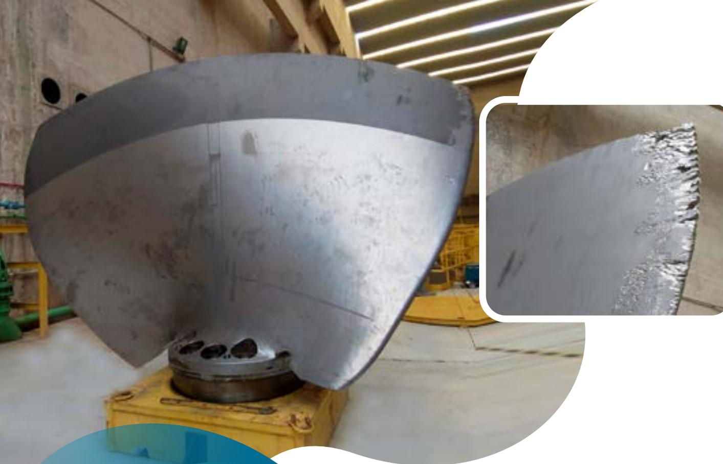
Será aplicado por aspersão térmica um revestimento adicional, que visa atingir elevados índices de resistência ao desgaste dos dois fenômenos de degradação
